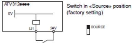
Switch in «Source» position (factory setting)
